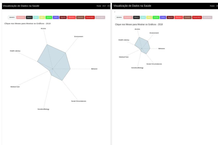
**Figura 4.4** Figura A - visualização responsiva utilizando o método *windows.onresize* adaptando-se ao tamanho de tela no Ipad Pro. Figura B sem o método *windows.onresize* de modo a não variar o tamanho do gráfico em uma tela de maior dimensão no Ipad Pro.
