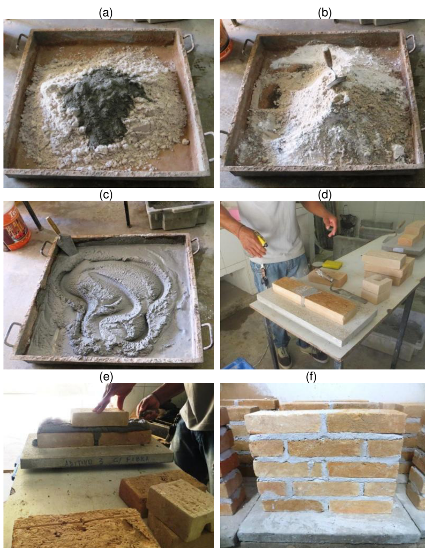
Figura 35 (a até f) – Confeção dos protótipos de alvenaria
