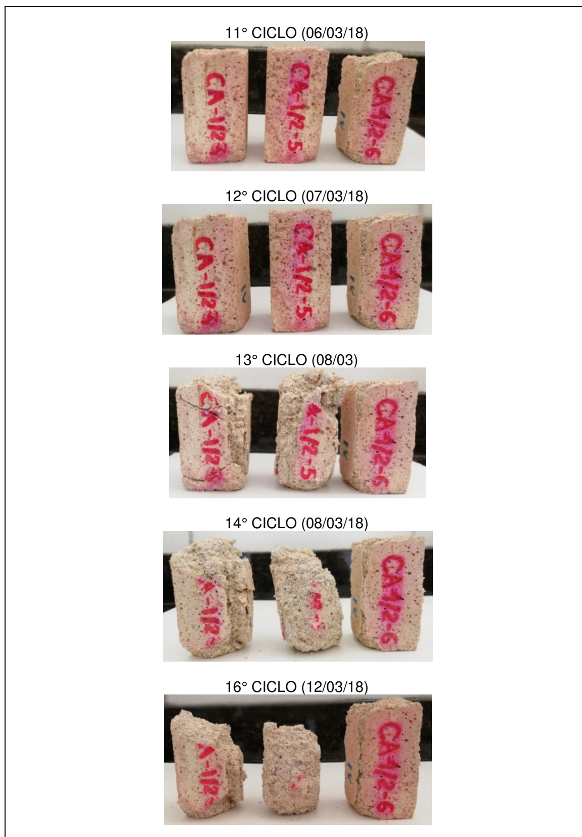
Figura D.16 – Ensaio de resistência aos sulfatos. Corpos de prova de CA-1/2: evolução ao longo dos ciclos de imersão e secagem
