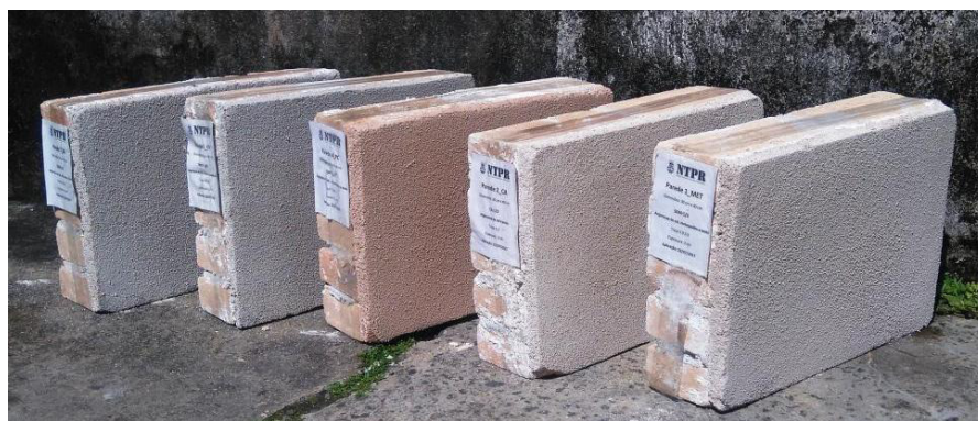
Figura 58 – Alvenarias com argamassas aplicadas: início da exposição natural
