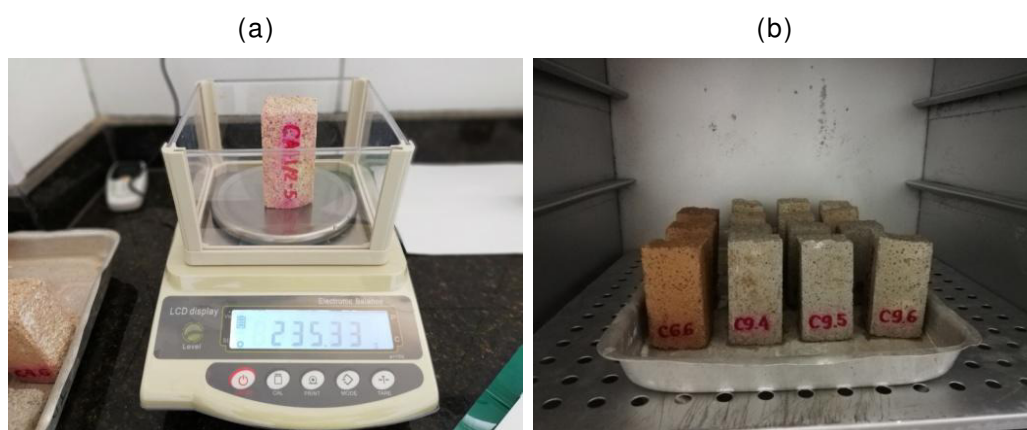
Figura 53 (a, b) – Ensaio de resistência aos sulfatos: pesagem e secagem após imersão em solução salina
