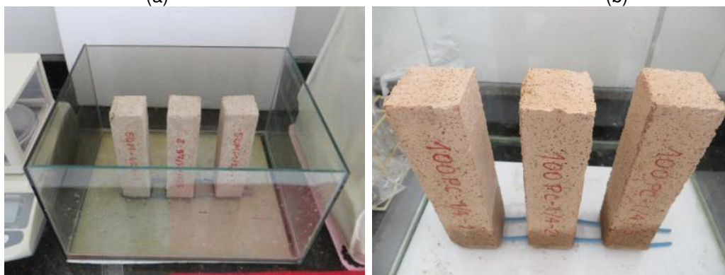
Figura 47 (a, b) – Ensaio de absorção de água por capilaridade (a) (b)
