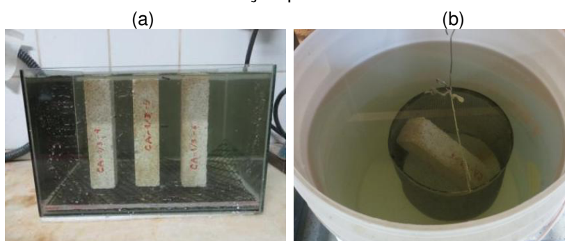
Figura 44 (a, b) – Ensaio de determinação da massa específica, índice de vazios e absorção por imersão
