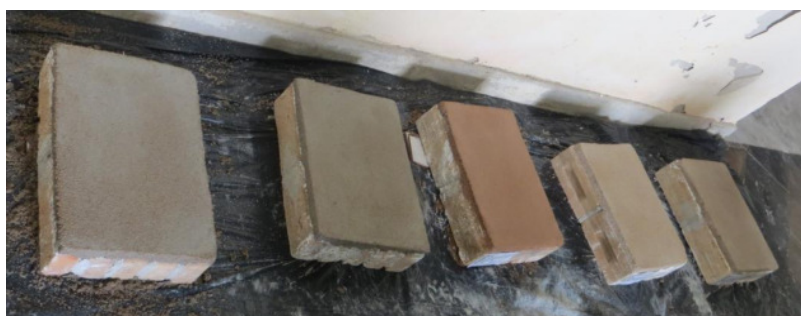
Figura 43 – Aspecto final das argamassas de revestimento nas alvenarias. Da esquerda para a direita: 50M-1/3; 50CV-1/3; 50PC-1/3; CA-1/2; 50SA-1/3
