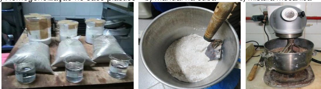
Figura 28 (a, b, c) – Mistura dos materiais para produção das argamassas estudadas a) Homogeneização no saco plástico b) Manual na cuba c) Mistura mecânica
