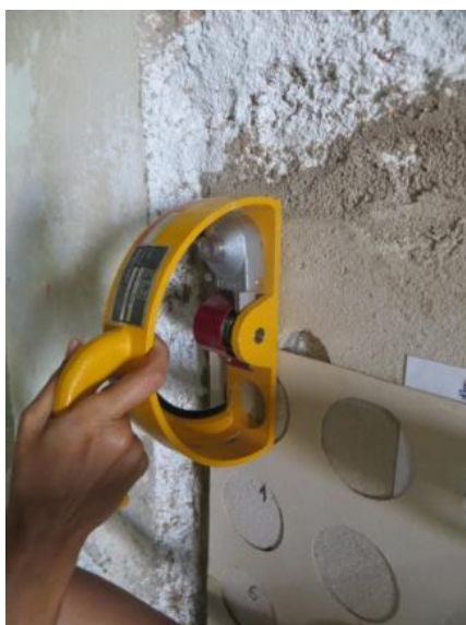
Figura 56 (a, b) – Ensaio de esclerômetro de pêndulo
