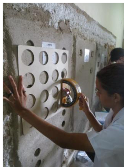
Figura 56 (a, b) – Ensaio de esclerômetro de pêndulo
