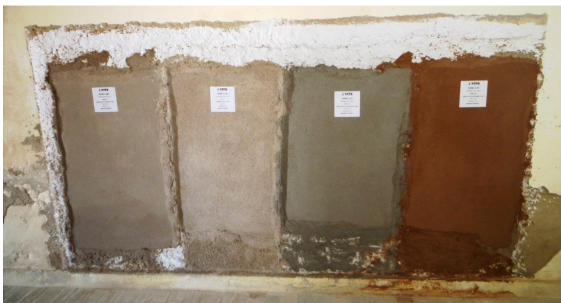
Figura 41 – Aspecto final dos revestimentos aplicados na Igreja de Monserrate. Da esquerda para a direita: 50M-1/3; CA-1/2; 50CV-1/3; 50PC-1/3
