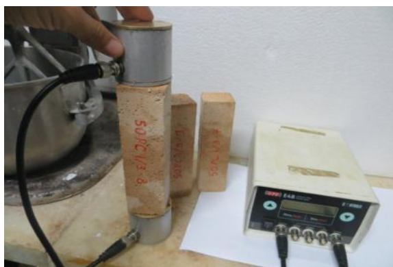
Figura 45 – Ensaio de módulo de elasticidade por meio de ultrassom
