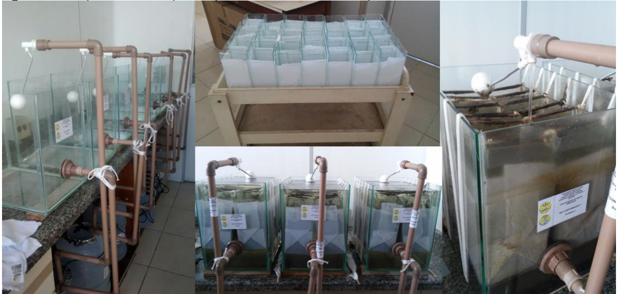
Figura 2 – Tanques e cubetas que compõem o sistema de remediação
