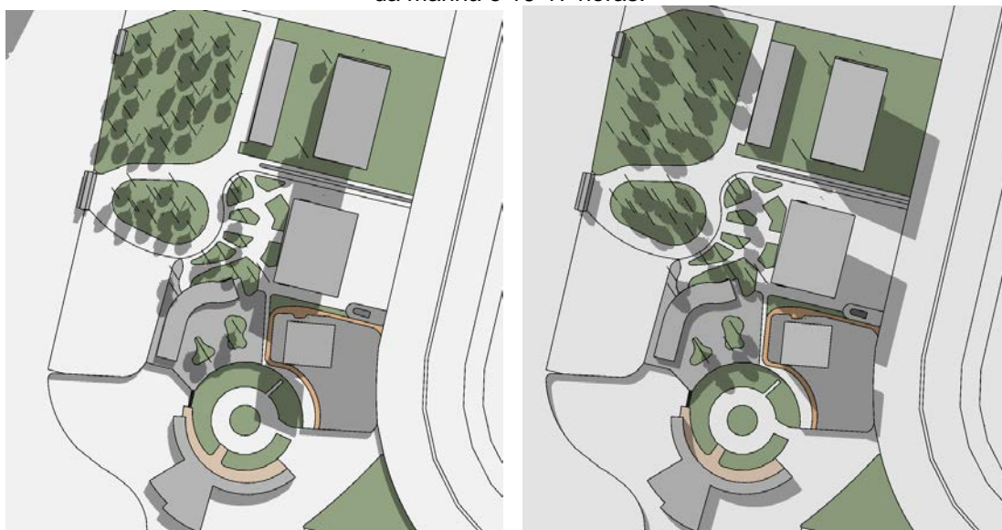
Figura 59 e 60 Respectivamente, simulação para o solstício de inverno (21 de junho) entre 9-10 horas da manhã e 16-17 horas.
