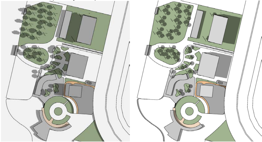
Figura 57 e 58 Primeira e segunda foto, respectivamente, simulação para o solstício de verão (21 de janeiro) entre 9-10 horas da manhã e 16-17 horas.
