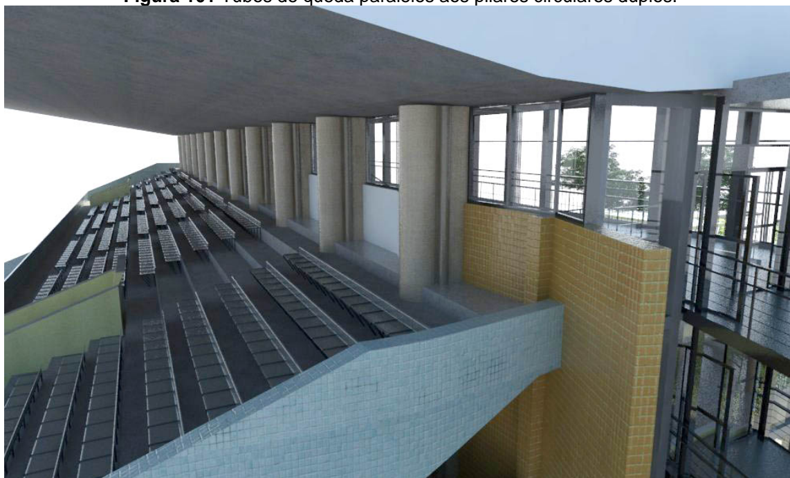
Figura 101 Tubos de queda paralelos aos pilares circulares duplos.
