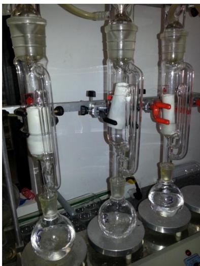
Figura 22: Sistema utilizado para a determinação de lipídeos, extração por Soxlet
