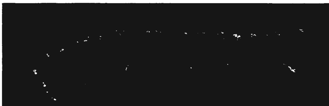
Figura 1 - Fotografia de trajetória (trilha) de elétron em uma câmara de Wilson
