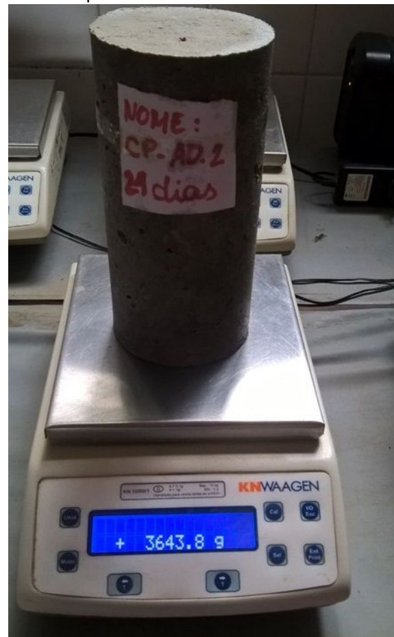
Figura 4.3 - Verificação da massa do corpo de prova de concreto com fibras
