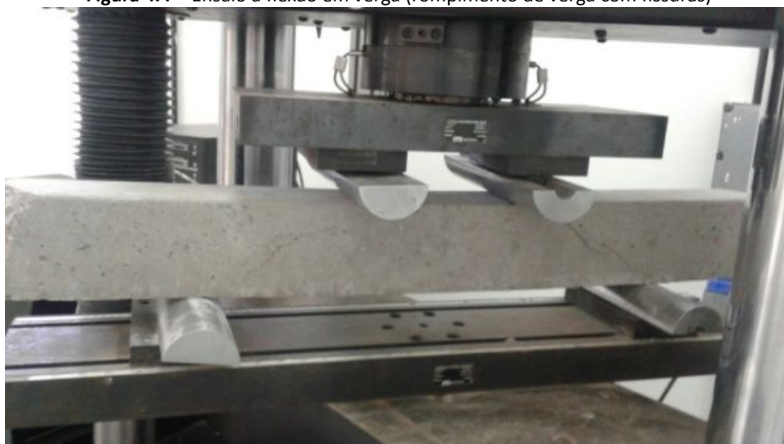
Figura 4.4 - Ensaio à flexão em verga (rompimento de verga com fissuras)
