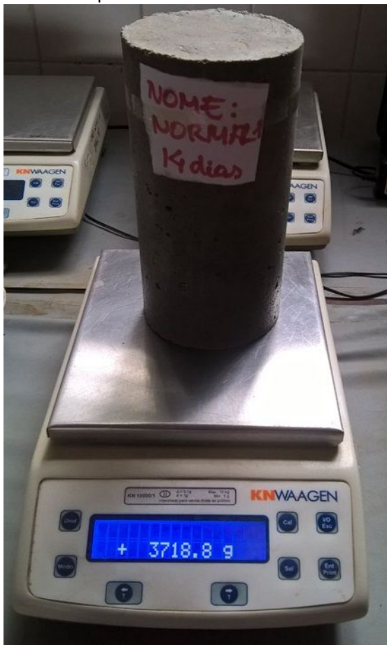
Figura 4.2 – Verificação da massa do corpo de prova de concreto normal
