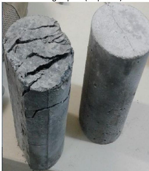
Figura 4.1 - Corpos de prova submetidos à resistência à tração por compressão diametral – amostragem do concreto da verga tipo B (esquerda) e da verga tipo A (direita)
