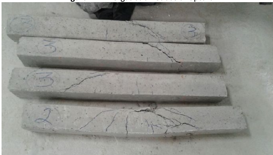
Figura 4.7 – Vergas submetidas à ruptura
