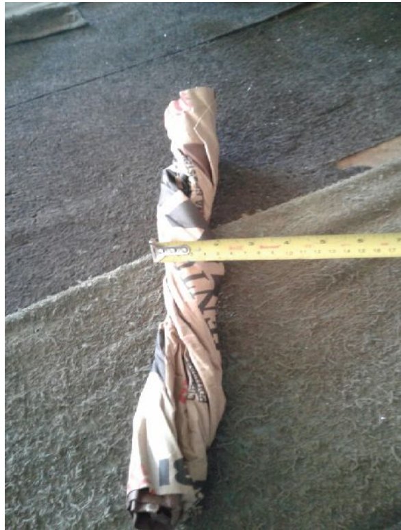
Figura 3.7 - Embalagem de um dos sacos de cimento Portland torcido em forma de cilindro ( \varnothing=5,16.10^{-2}m ; h=4,8.10^{-1}m )
