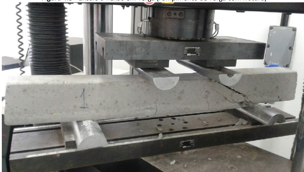
Figura 4.5 - Ensaio à flexão em verga (rompimento de verga com fratura)
