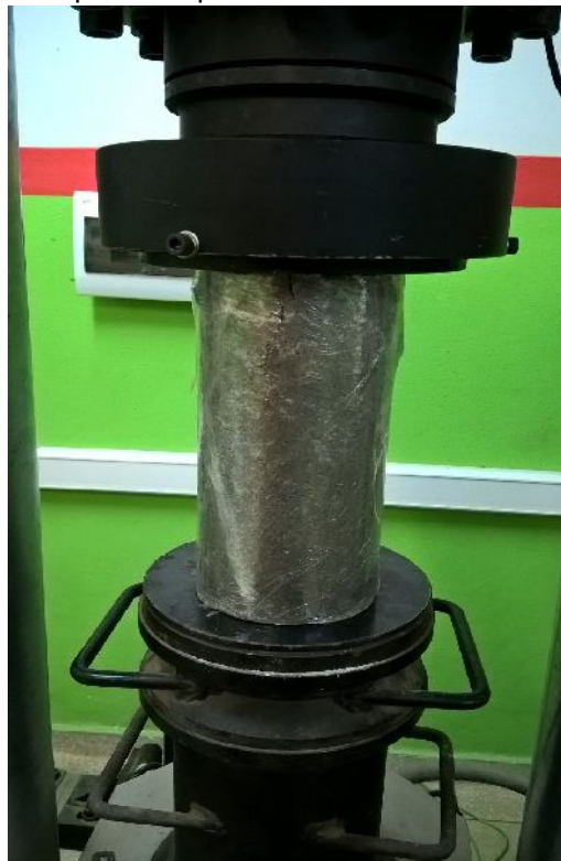
Figura 3.6 - Corpo de prova na prensa de ensaio de resistência à compressão
