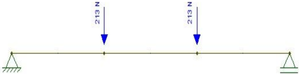
Figura 3.13 - Adaptação das cargas para realização de ensaios
