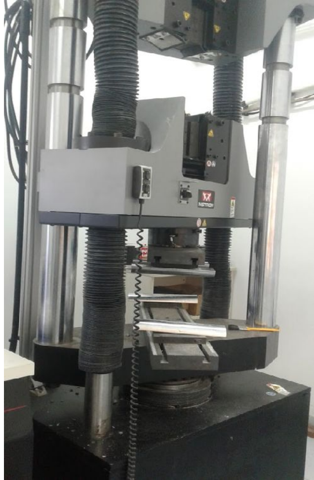
Figura 3.15 - Máquina para verificação de carga e deslocamento das vergas
