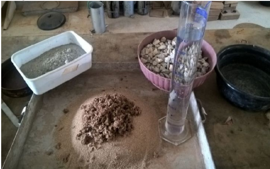
Figura 3.3 - Fibra substituindo 5% da massa do agregado miúdo (areia)
