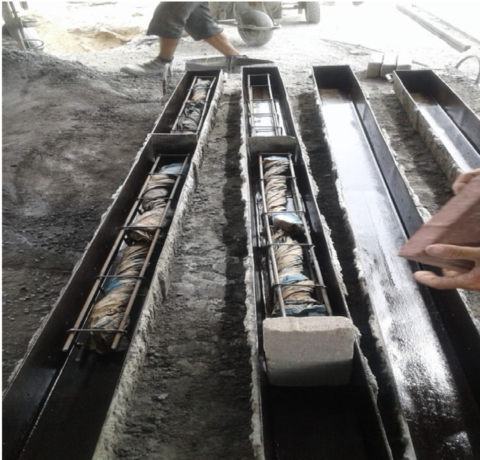
Figura 3.10 - Produção das vergas tipos A e B, com embalagens retorcidas na parte interna
