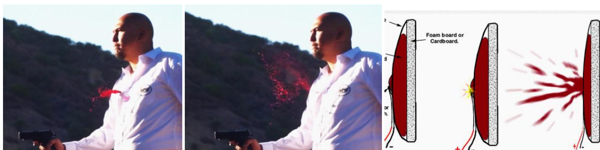
Figura 116: Funcionamento dos Squibs (Dispositivos Explosivos)
