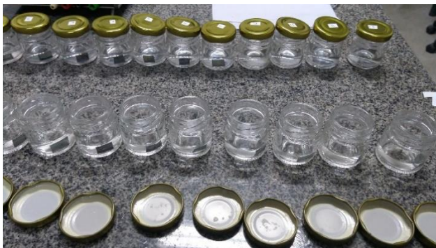
Figura 20: Ensaio de Perda de massa em solução 0,5 mol NaCl
