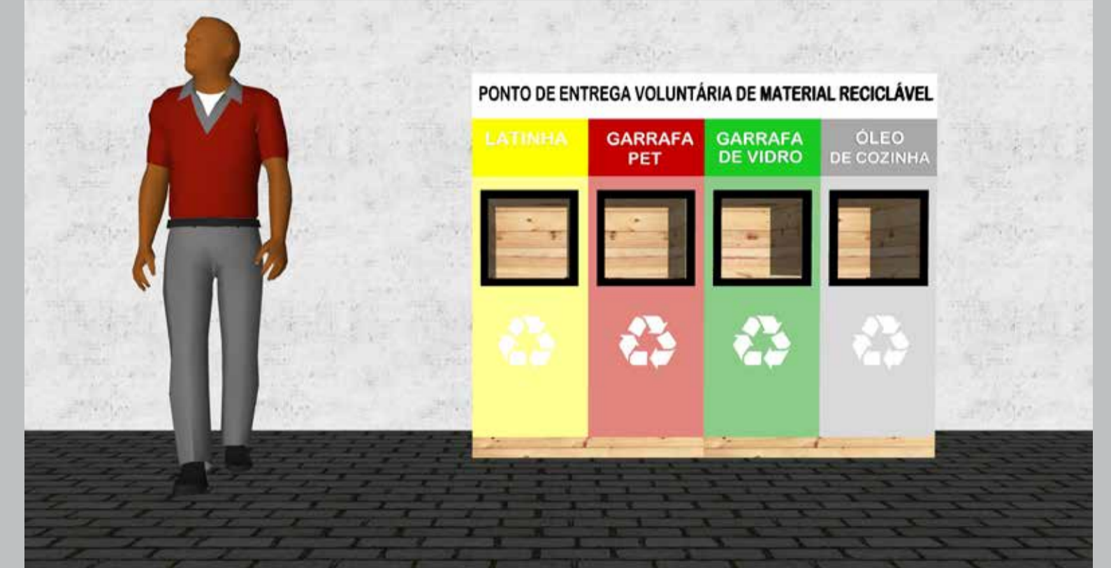
Protótipo do Ponto de Entrega Voluntária de Material Reciclável específico para a população local (latinha, garrafa pet, garrafa de vidro e óleo de cozinha) confeccionado em material reciclável (pallet).
