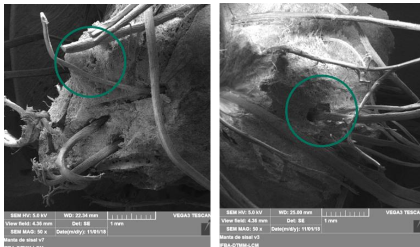
Figura 53 e 54. Falhas de aderência entre a manta de sisal e a matriz de gesso.
