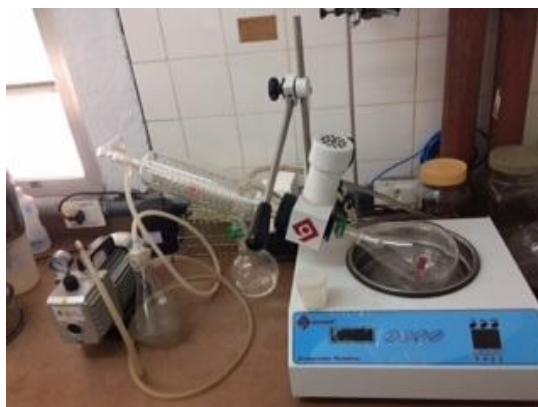
FIGURA 12. Representação do modelo do Evaporador Rotatório utilizado para o processo de produção dos extratos
