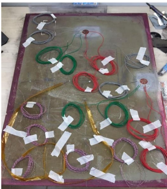
Figura 18 – Chapa de aço após instalação dos termopares e rosetas.
