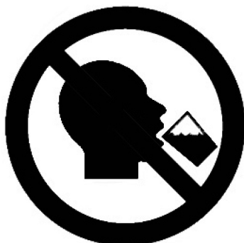
Figura 5.27 – Sugestões de identificação gráfica para peças e pontos de utilização de água não potável
