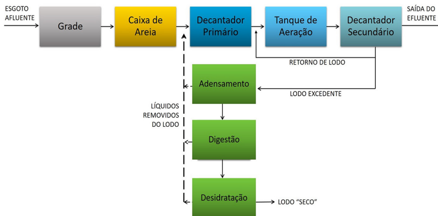
Figura 4.19 – Fluxograma do processo de lodo ativado de alta taxa e convencional
