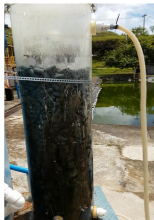
Figura 7.19c – Câmara de Dessorção com Preenchimento – Demonstração
