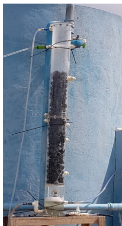
Figura 7.19a – Câmara de Dessorção com Preenchimento – Piloto
