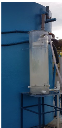
Figura 7.19b – Câmara de Dessorção Simplificada – Demonstração
