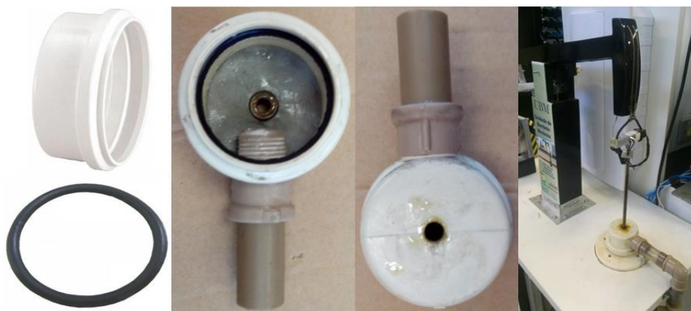
Figura 5.3-6. Cap de 50 mm e anel de vedação à esquerda, cabeça de produção à direita
