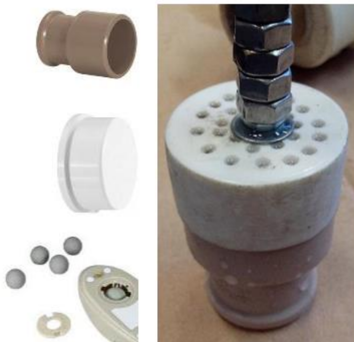
Figura 5.3-12. Materiais utilizados para a produção da válvula de pé à esquerda, pistão e válvula de passeios mantados à direita
