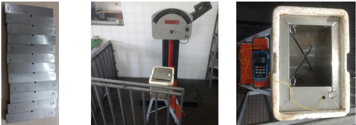
Figura 42 – Esquema de execução do ensaio de Impacto Charpy .
