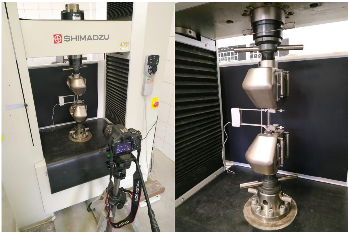
Figura 39 – Esquema de execução do ensaio de tração.
