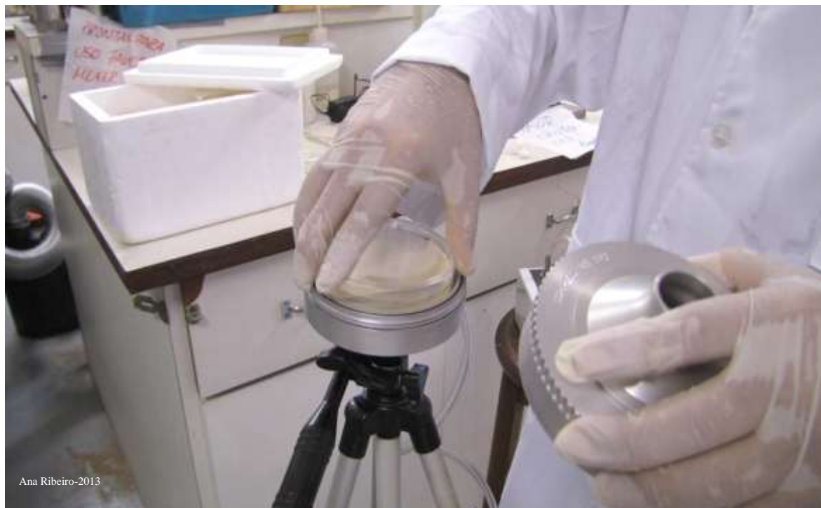
Figura 23 - Placa Petrifilm com meio de cultura para fungos no impactador Andersen
