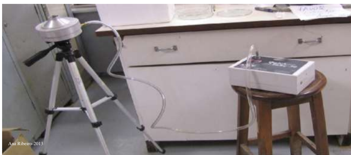
Figura 22 – Conjunto impactador Andersen e bomba de amostragem
