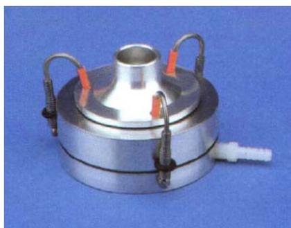
Figura 19 – Impactador Andersen montado para amostragem com um estágio
