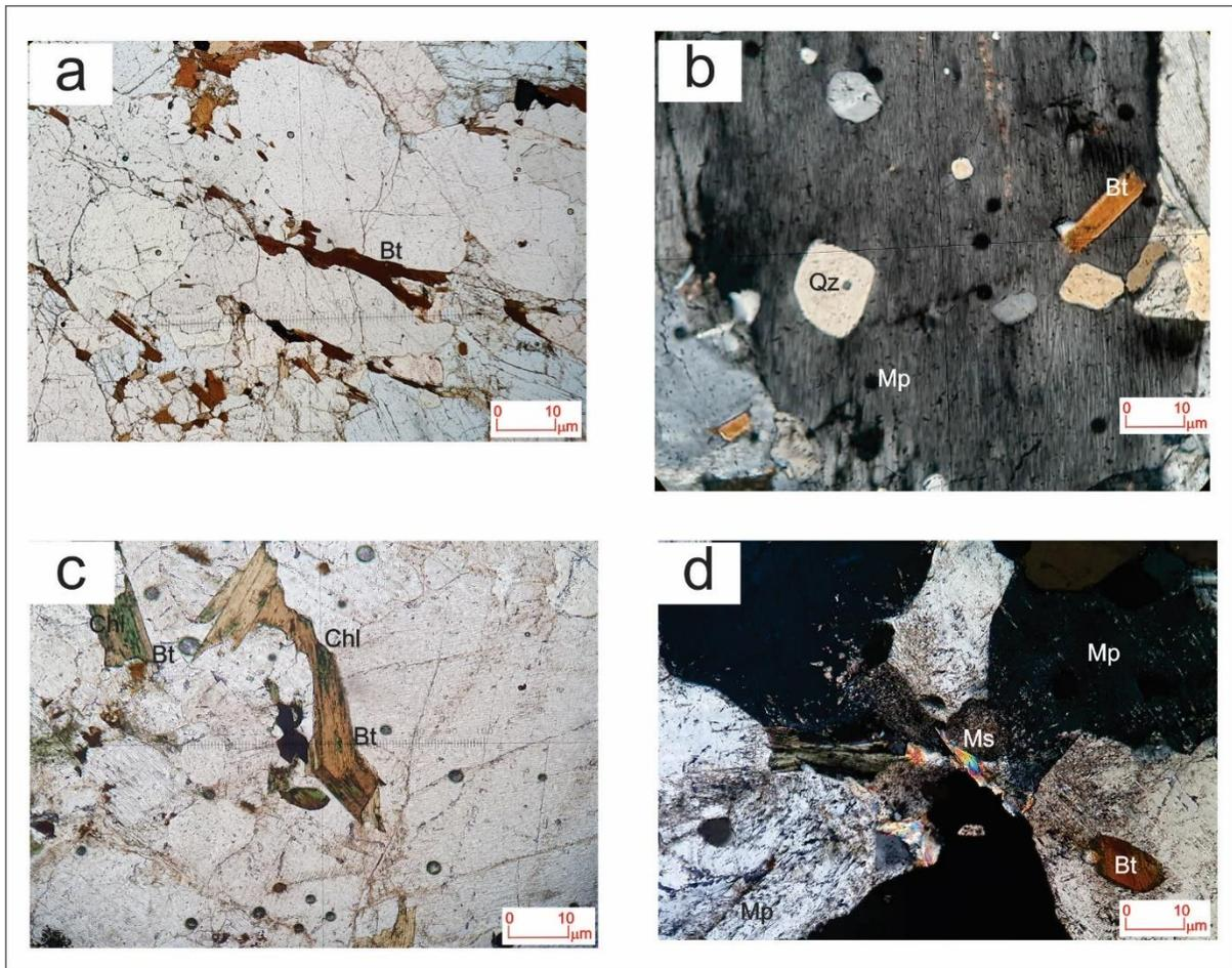
Figura 6 – Microestruturas nas rochas da SII. (a) Deformação incipiente marcada principalmente pela orientação dos cristais de biotita, marcando a textura lepidoblástica (Lp); (b) Textura poiquiloblástica marcada pela inclusão de cristais de quartzo e biotita em grande cristal de mesopertita (Nx); (c) Processo de cloritização da biotita (Lp); e, (d) Processo alteração da biotita para moscovita (Nx). Mp – Mesopertita, Bt – Biotita, Qz – Quartzo, Mc – Microclinio, Chl – Clorita, Ms – Moscovita.
