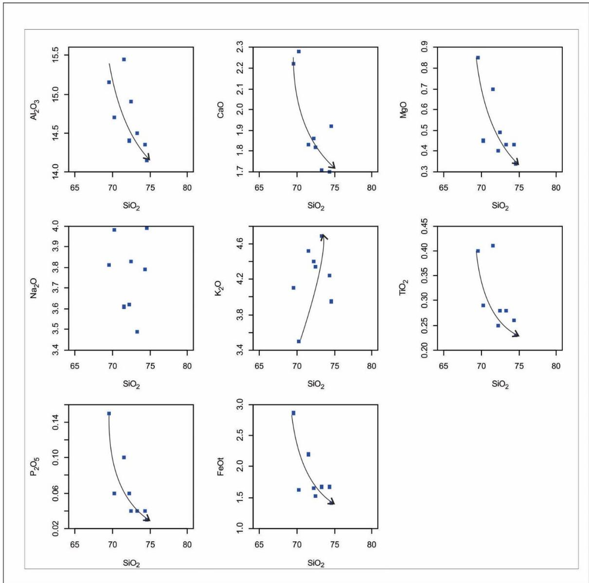
Figura 8 – Elementos maiores das rochas intrusivas em relação à sílica plotados nos diagramas de Harker (1909).
