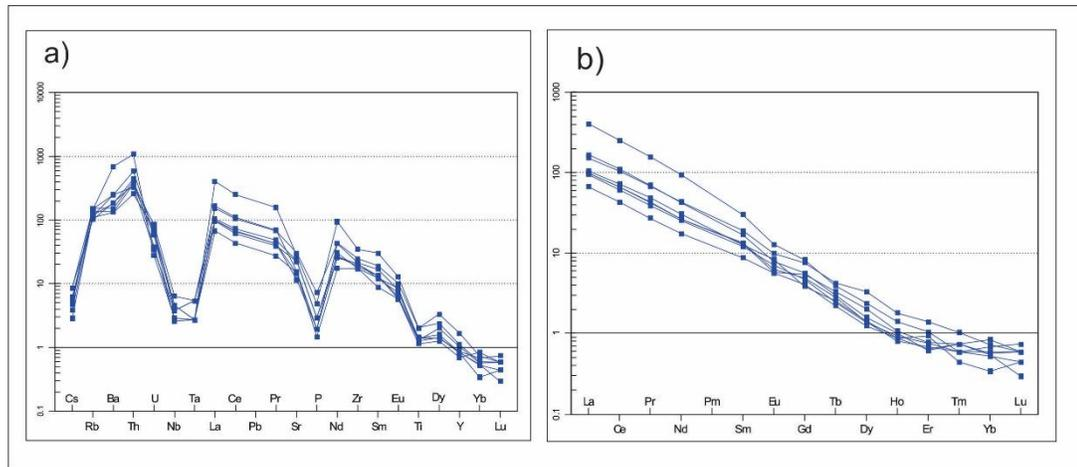
Figura 11 – Diagramas de elementos traço para as rochas intrusivas: a) Diagrama de Elementos Terras Raras; e, b) Diagrama multielementar. Ambos normalizados pelo manto primitivo segundo (McDonough & Sun, 1995).
