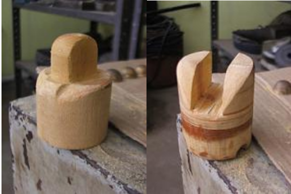
Figura 17 Peça em madeira, articulações dos joelhos e cotovelos dos bonecos. Figura 18 Peça para as articulações dos bonecos.
