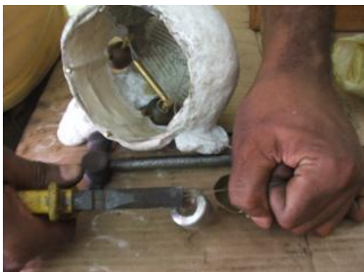
Figura 23 Cabeça, protótipo para o estudo do mecanismo de movimento dos olhos e pálpebras.
