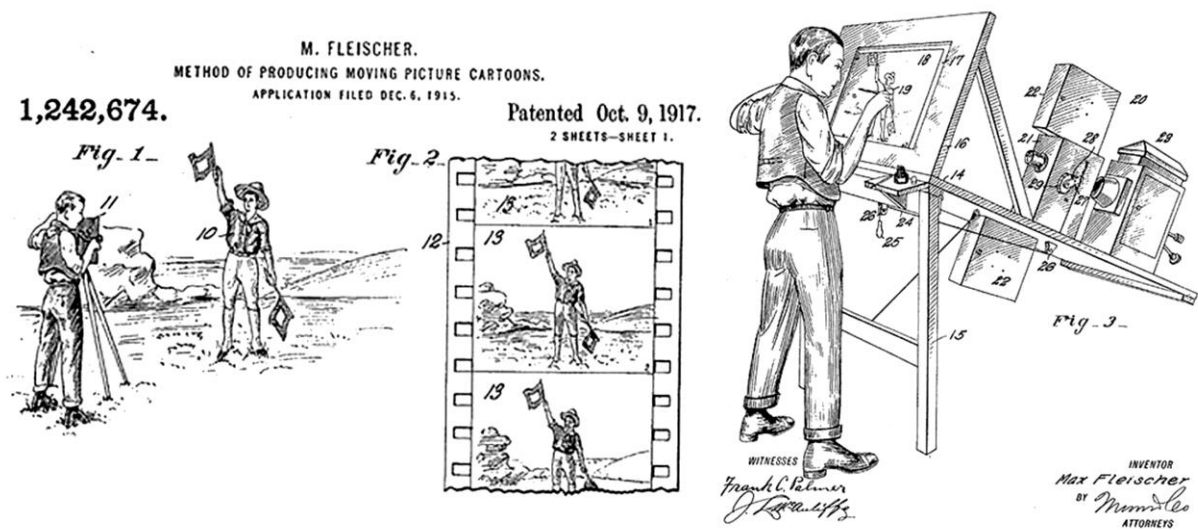
Figura 20 – Max Fleischer: patente do rotoscópio , 1915.
