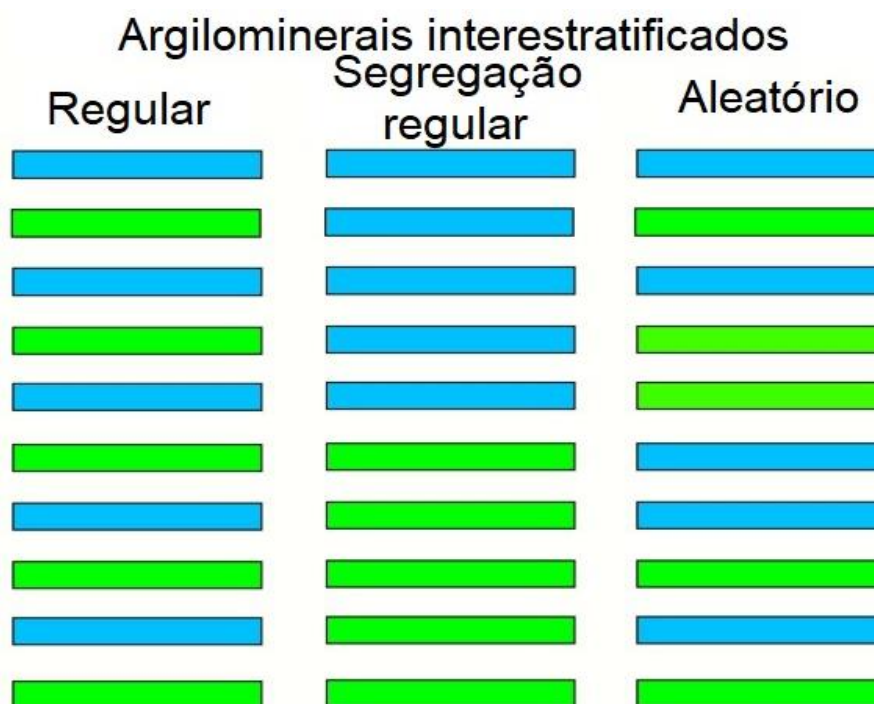
Figura 3.13 - Modelo esquemático da estruturação de camadas dos argilominerais interestratificados.
