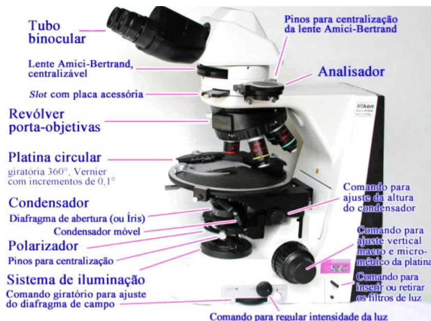
Figura 2.1 - Componentes do microscópio de luz transmitida polarizada (Nikon Eclipse 50/Pol; Leica Laborlux 12 Pol).
