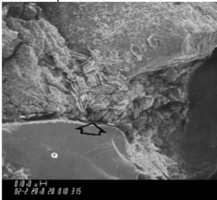
Imagem 3.4 - Pilhas e alongados "verms" de caulinita preenchendo espaço poroso entre grãos detríticos de quartzo aumentado em 2000x.
