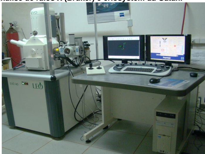
Imagem 2.1 - Microscópio Eletrônico de Varredura (MEV), LEO EVO 40 XVP, com sistema de microanálise de raios X (Bruker) e criosystem da Gatan.
