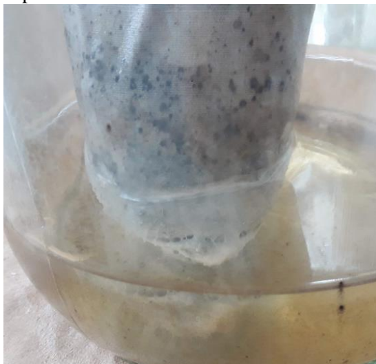
Figura 12 – Biofilme registrado na condição experimental BGS, Bioaumentação associada à bioestimulação, após 15 dias de experimento
