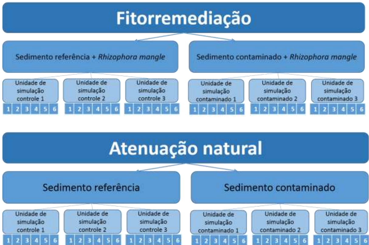
Figura 3 - Delineamento ilustrativo do processo experimental da fitorremediação para a Rhizophora mangle , e da atenuação natural
