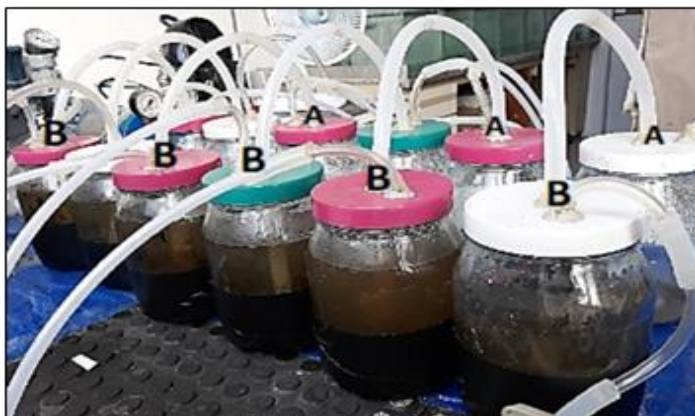
Figura 6 - Reator em maré alta, a água sai do reator A e vai para o reator B cobrindo o sedimento com água
