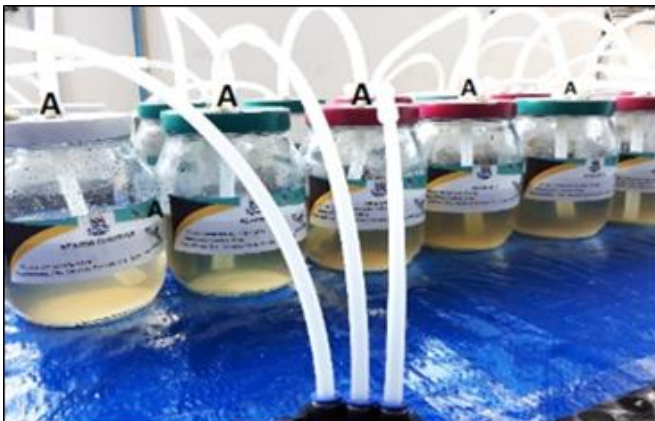
Figura 5 - Reator em maré baixa, a água sai do reator B, e vai para o reator A
