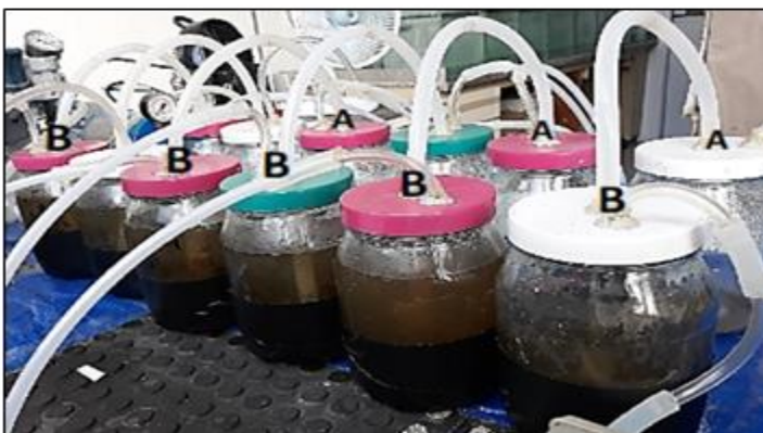
Figura 15 - Reator em maré alta, a água sai do reator A e vai para o reator B cobrindo o sedimento com a água
