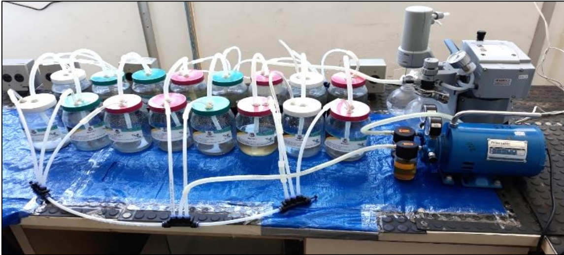
Figura 7- Experimento de biorremediação de sedimento de manguezal com petróleo
