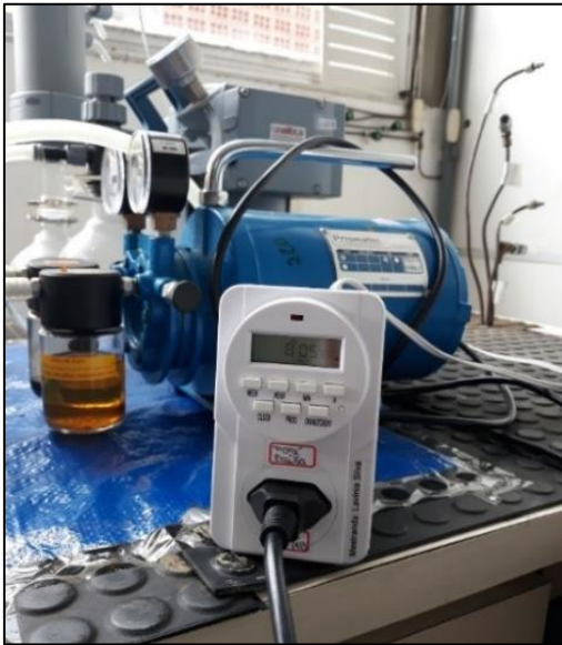
Figura 12 - Time temporizador digital, liga e desliga a bomba Á vácuo a cada 6 horas, promovendo o movimento da água de um reator para o outro simulando o sistema de maré
