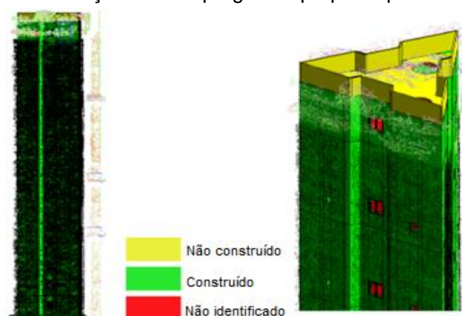
Figura 10 – Exemplo de ilustrações 3D do progresso proposta por Qu et al. (2017)
