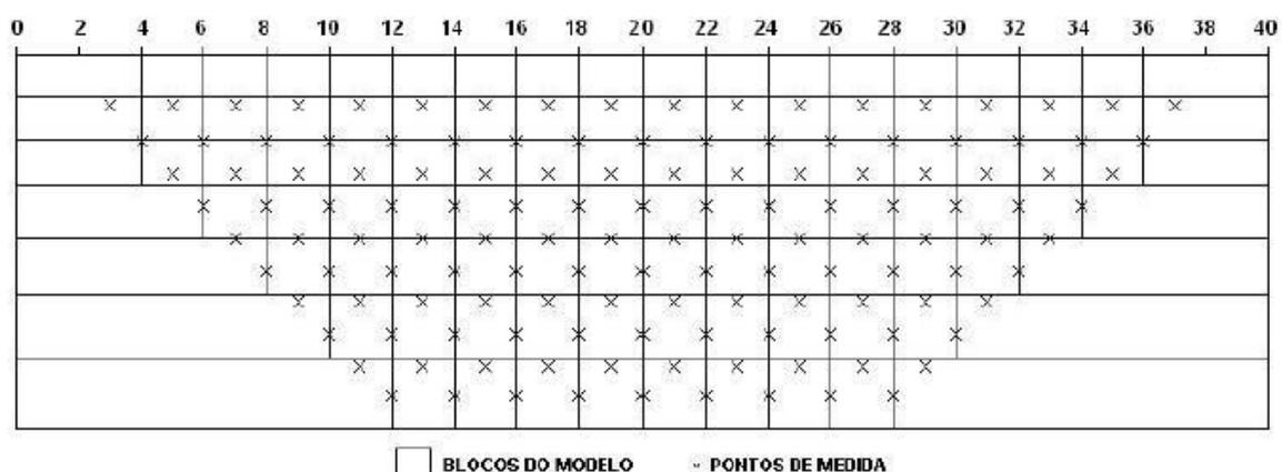
Figura 3.12 – Arranjo de blocos utilizado no modelo, juntamente com a posição dos pontos de medida da correspondente pseudo-seção. O arranjo de eletrodos utilizado foi o Dipolo-Dipolo (GEOTOMO SOFTWARE, 2004).
