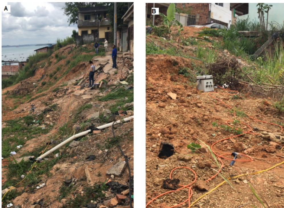
Figura 4.13 – (A) Procedimento do CE linha 1 sendo montado na crista do talude (B) Procedimento do CE linha 2 sendo montado no platô.
