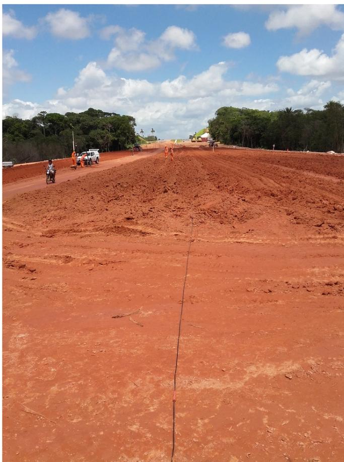
Figura 4.5 – Vista do aterro com o cabo que conecta o aparelho de eletrorresistividade aos eletrodos, os quais estão alinhados no sentido longitudinal da BA-093.
