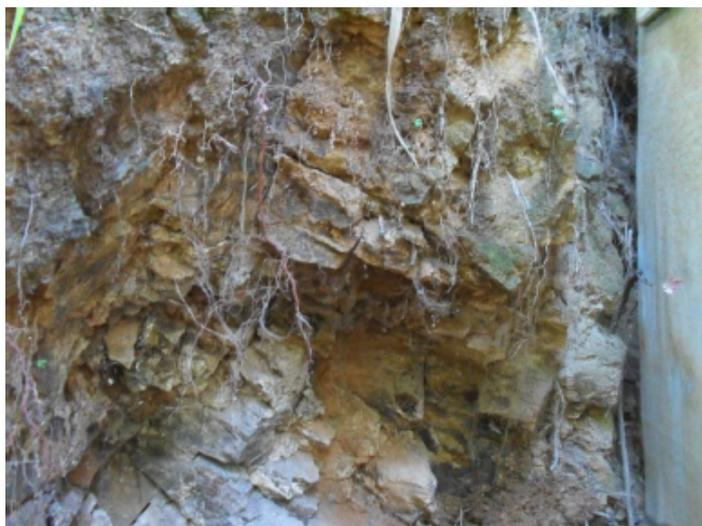
Figura 4.20 – Aspecto da rocha muito fraturada, alterada e pouco coerente, identificada num corte subvertical realizado por moradores (GEOENG, 2014).
