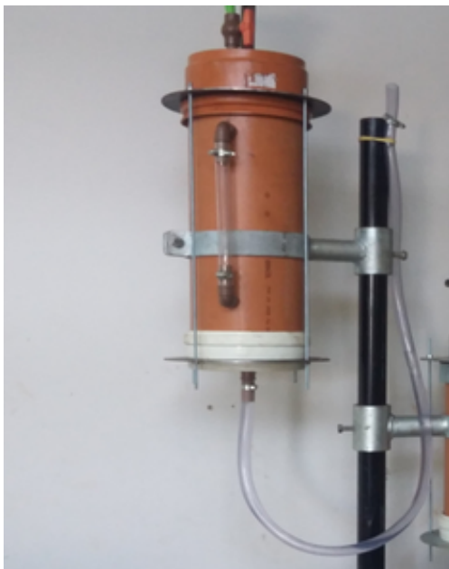
Figura 5.19: Foto Reservatório de Mariotte
