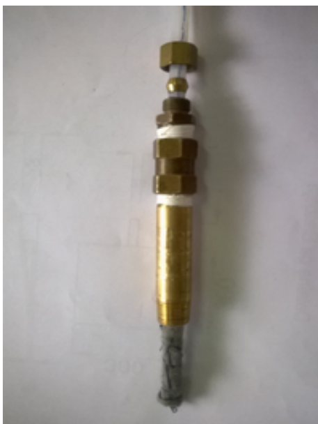
Figura 5.24: Detalhe do dreno lateral
