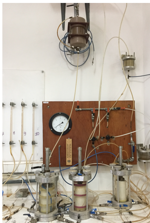
Figura 5.46: Sistema de Percolação
