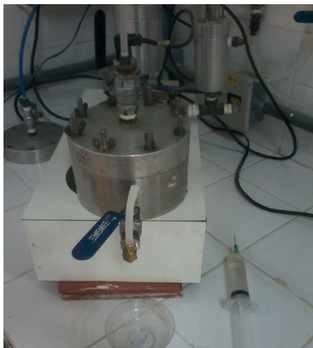
Figura 5.51: Câmara de Pressão vedada durante ensaio
