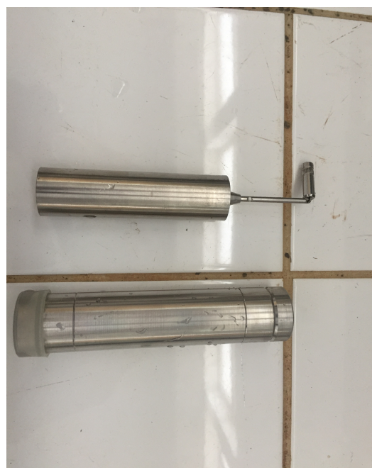
Figura 5.16: Foto Cilindro Metálico e Paleta
