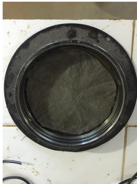
Figura 5.26: Foto da vista interna do cabeçote superior e o-rings Figura 5.27: Foto da vista interna do cabeçote inferior com geotêxtil
