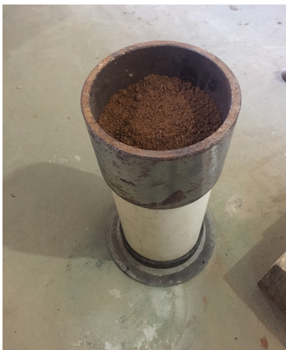
Figura 5.36: Colarinho superior de compactação e cabeçote inferior, fixados no corpo de prova
