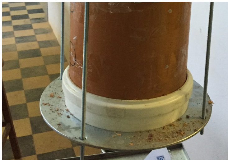
Figura 5.28: Cabeçote inferior e travamento (esquema inicial)
