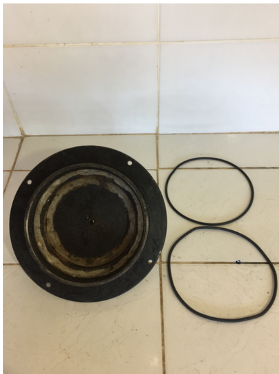
Figura 5.26: Foto da vista interna do cabeçote superior e o-rings Figura 5.27: Foto da vista interna do cabeçote inferior com geotêxtil
