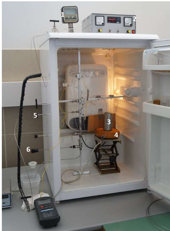
Figura 32. Sistema de impregnação/deposição usando fluido supercrítico (SSI/SSD), formado por um manômetro digital (1), termostato digital (2), célula de impregnação/deposição (aço inoxidável) para processos de alta pressão dentro de banho termostático de ar (3), agitador magnético (4), válvulas de alta pressão de agulha de precisão (5) e válvula micrométrica (6)
