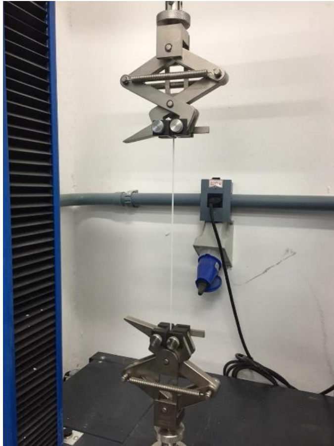
Figura 28 – Ensaio de tração em filamento polimérico.
