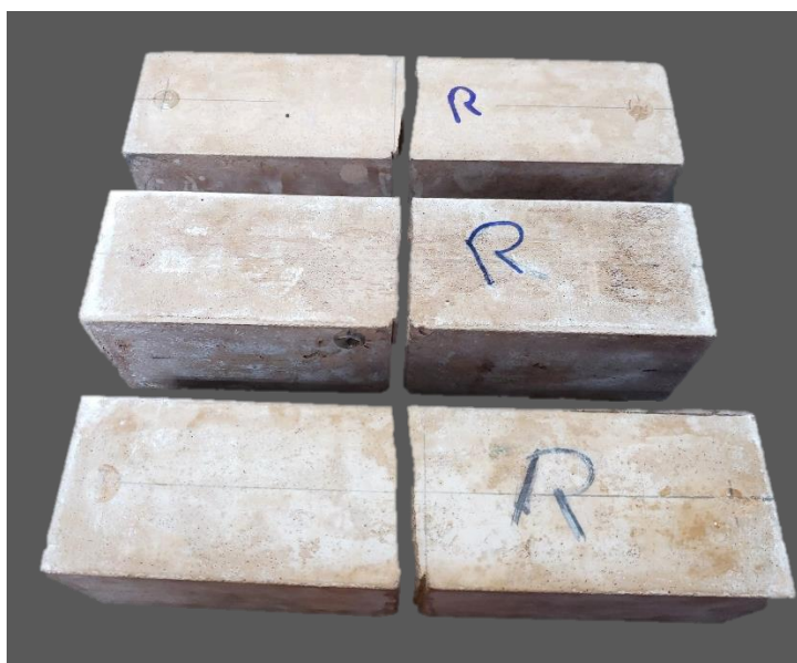
Figura 60 – Vista frontal dos corpos de prova do grupo REF após ensaio de fratura.
