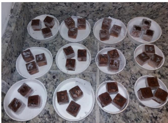
Figura 26 – Corpos de prova após a ocorrência da eflorescência.
