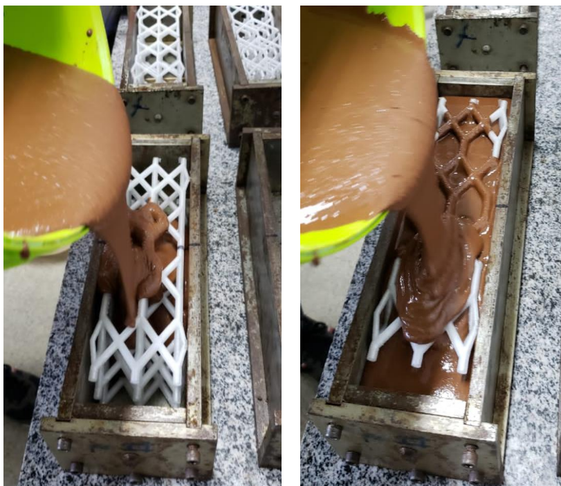
Figura 33 – Posicionamento das malhas e lançamento da AGAA na forma.
