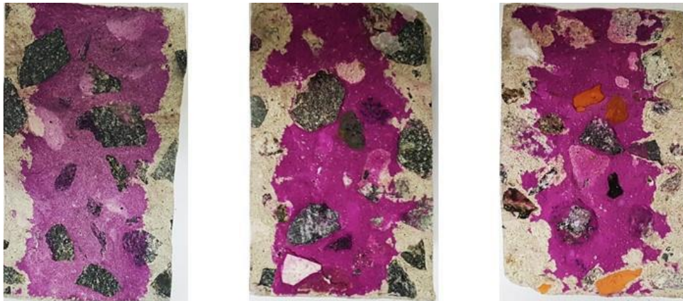
Figura 20. Amostras de concreto submetidas à aspensão de solução contendo fenolftaleína.
