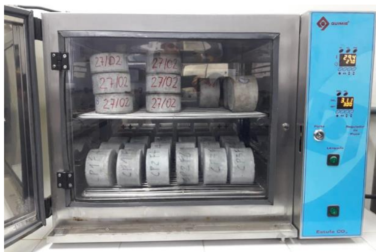
Figura 34. Câmara utilizada para realização do ensaio de carbonatação nos concretos.
