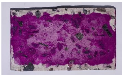
Figura 36. Profundidade de carbonatação em corpo de prova após aspersão de fenolftaleína.
