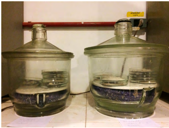
Figuras 178, 179, 180 Amostras das paredes I e II no dessecador para serem resfriadas; amostras secas das paredes I e II pesadas na balança analítica
