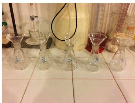
Figuras 213, 214, 215 amostras III, IV e V após moagem no gral de porcelana; organização da vidraria para realização do teste de sais solúveis; amostras I-2A, II-2A, III, IV e V organizadas para pesagem de 10g;
