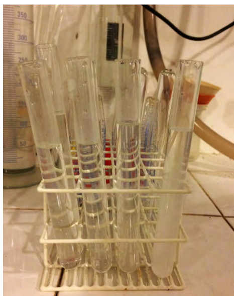
Figuras 225, 226, 227 filtrado depositado em tubos de ensaio; reação do filtrado à presença do reativo, ácido clorídrico (HCl) concentrado e solução de 5% de cloreto de bário (BaCl 2 ); resultado na amostra III
