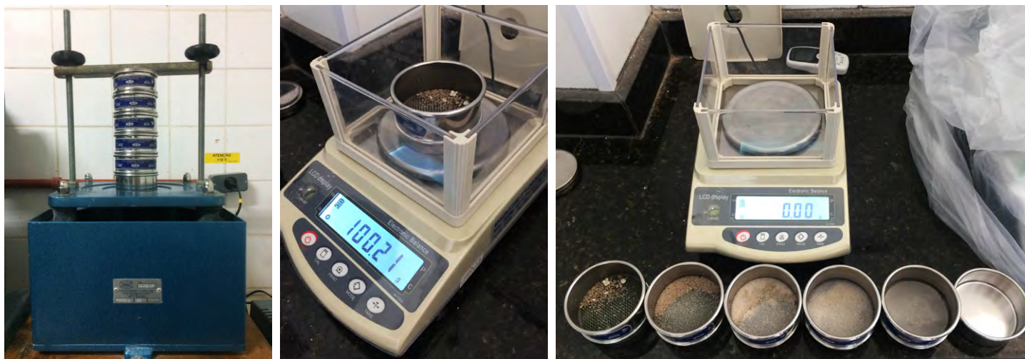
Figuras 201, 202, 203 Agitador de peneiras; material retido pela peneira nº16; areia retida em cada uma das peneiras
