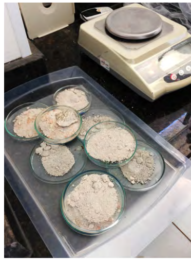
Figuras 178, 179, 180 Amostras das paredes I e II no dessecador para serem resfriadas; amostras secas das paredes I e II pesadas na balança analítica
