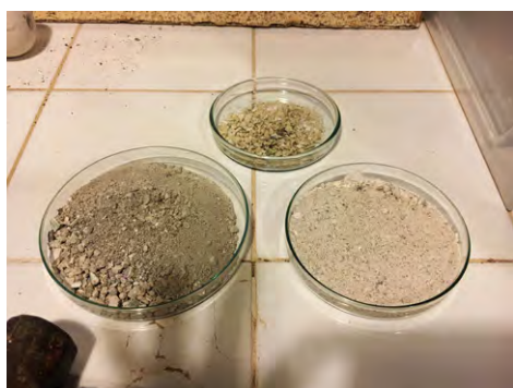
Figuras 213, 214, 215 amostras III, IV e V após moagem no gral de porcelana; organização da vidraria para realização do teste de sais solúveis; amostras I-2A, II-2A, III, IV e V organizadas para pesagem de 10g;
