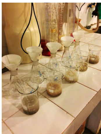
Figuras 216, 217 amostra no béquer; hidratação e agitação da amostra com água deionizada, para solubilização dos sais
