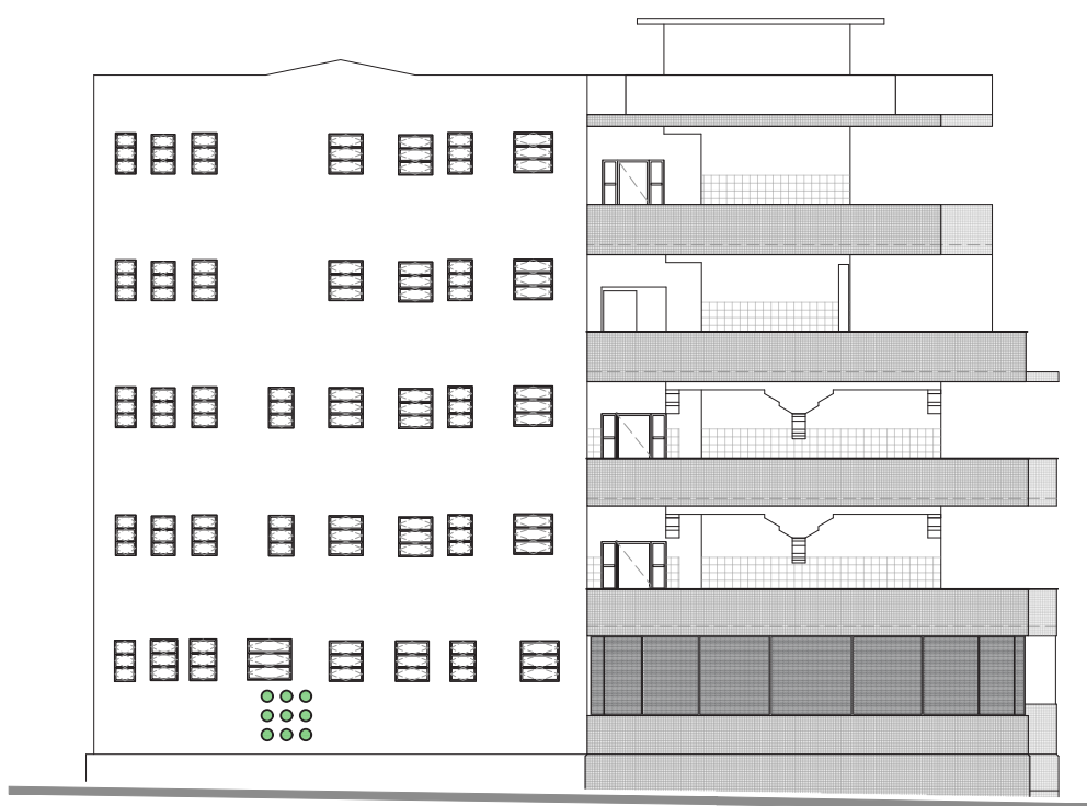
Figura 176 posição das amostras retiradas em relação à fachada. acima, marcação e teor de umidade verificado em cada uma das amostras
