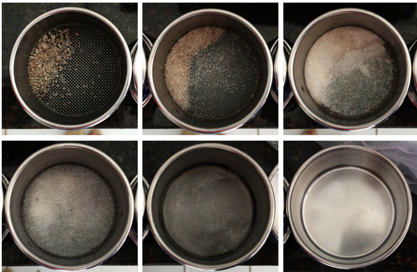
Figuras 204, 205, 206, 207, 208, 209 Da esquerda para a direita, de cima para baixo: material retido nas peneiras nº 16, nº 35, nº 60, nº 100, nº 200, nº >200
