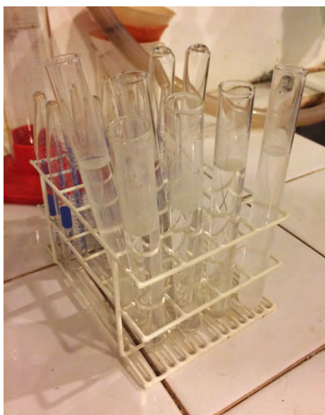
Figuras 225, 226, 227 filtrado depositado em tubos de ensaio; reação do filtrado à presença do reativo, ácido clorídrico (HCl) concentrado e solução de 5% de cloreto de bário (BaCl 2 ); resultado na amostra III
