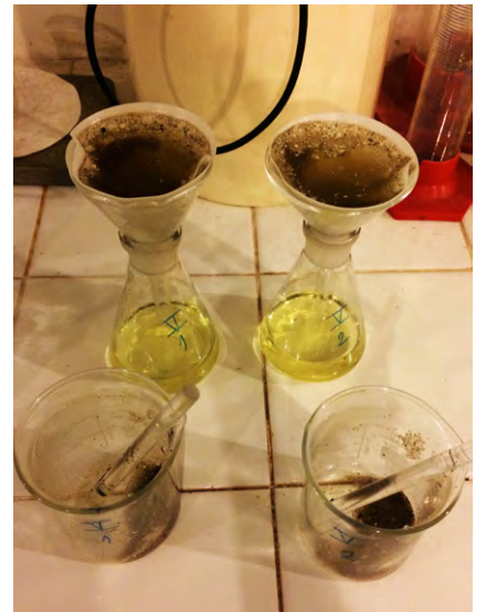
Figuras 192, 193, 194 (à direita, de cima para baixo): transferência das amostras III e V (em duplicata) hidratadas com água deionizada para filtro de papel no funil e balão de Erlenmeyer;
