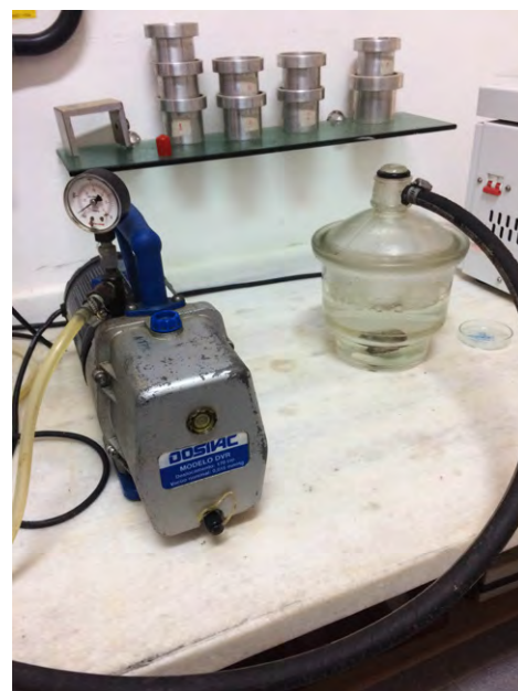
Figuras 210, 211, 212 Peso da amostra úmida de concreto; reação da amostra ao entrar em contato com algumas gotas de ácido clorídrico; amostras de concreto em recipiente de vidro acoplado a uma bomba de alto vácuo
