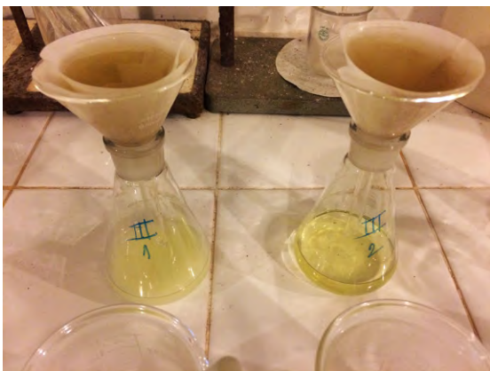
Figuras 192, 193, 194 (à direita, de cima para baixo): transferência das amostras III e V (em duplicata) hidratadas com água deionizada para filtro de papel no funil e balão de Erlenmeyer;
