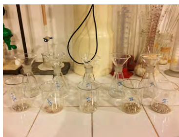
Figuras 216, 217 amostra no béquer; hidratação e agitação da amostra com água deionizada, para solubilização dos sais
