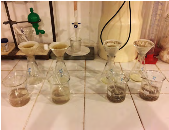
Figuras 188, 189, 190, 191 (abaixo) cor da solução da amostra III com água deionizada; cor da solução da amostra V com água deionizada; filtragem da solução da amostra III; filtragem da solução da amostra V
