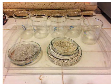
Figuras 213, 214, 215 amostras III, IV e V após moagem no gral de porcelana; organização da vidraria para realização do teste de sais solúveis; amostras I-2A, II-2A, III, IV e V organizadas para pesagem de 10g;
