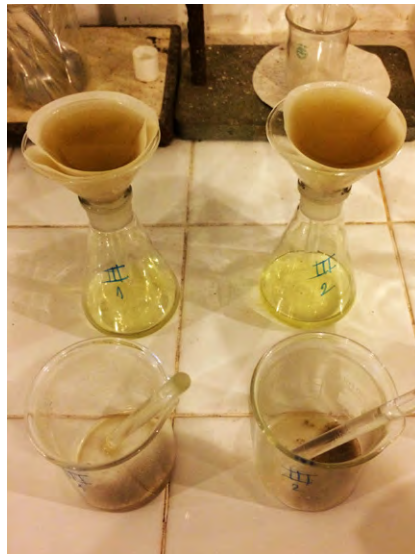
Figuras 192, 193, 194 (à direita, de cima para baixo): transferência das amostras III e V (em duplicata) hidratadas com água deionizada para filtro de papel no funil e balão de Erlenmeyer;
