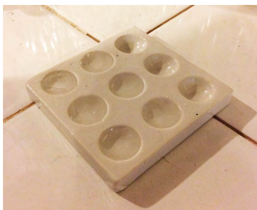
Figuras 220, 221 distribuição do material filtrado nas saliências da placa de toque; reação do filtrado à presença do reativo, 1% de difenilamina em ácido sulfúrico ( H_2SO_4 ) concentrado
