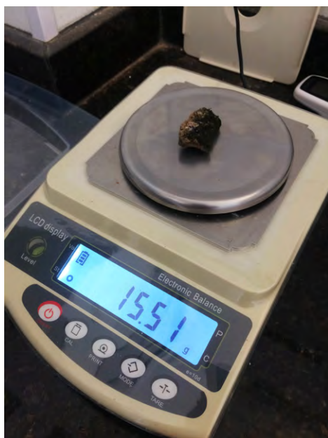
Figuras 210, 211, 212 Peso da amostra úmida de concreto; reação da amostra ao entrar em contato com algumas gotas de ácido clorídrico; amostras de concreto em recipiente de vidro acoplado a uma bomba de alto vácuo
