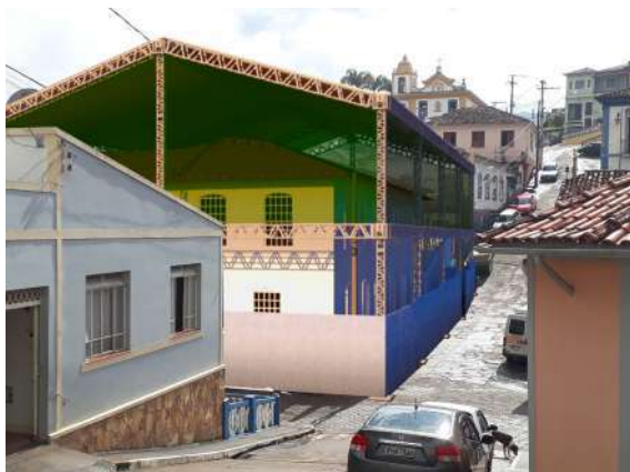
Figura 211 - Proposta de cobertura provisória
