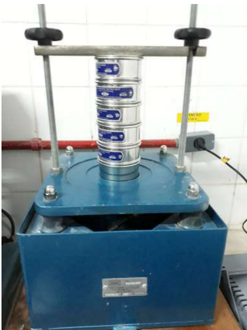
Figura 176 - Peneiramento das amostras
