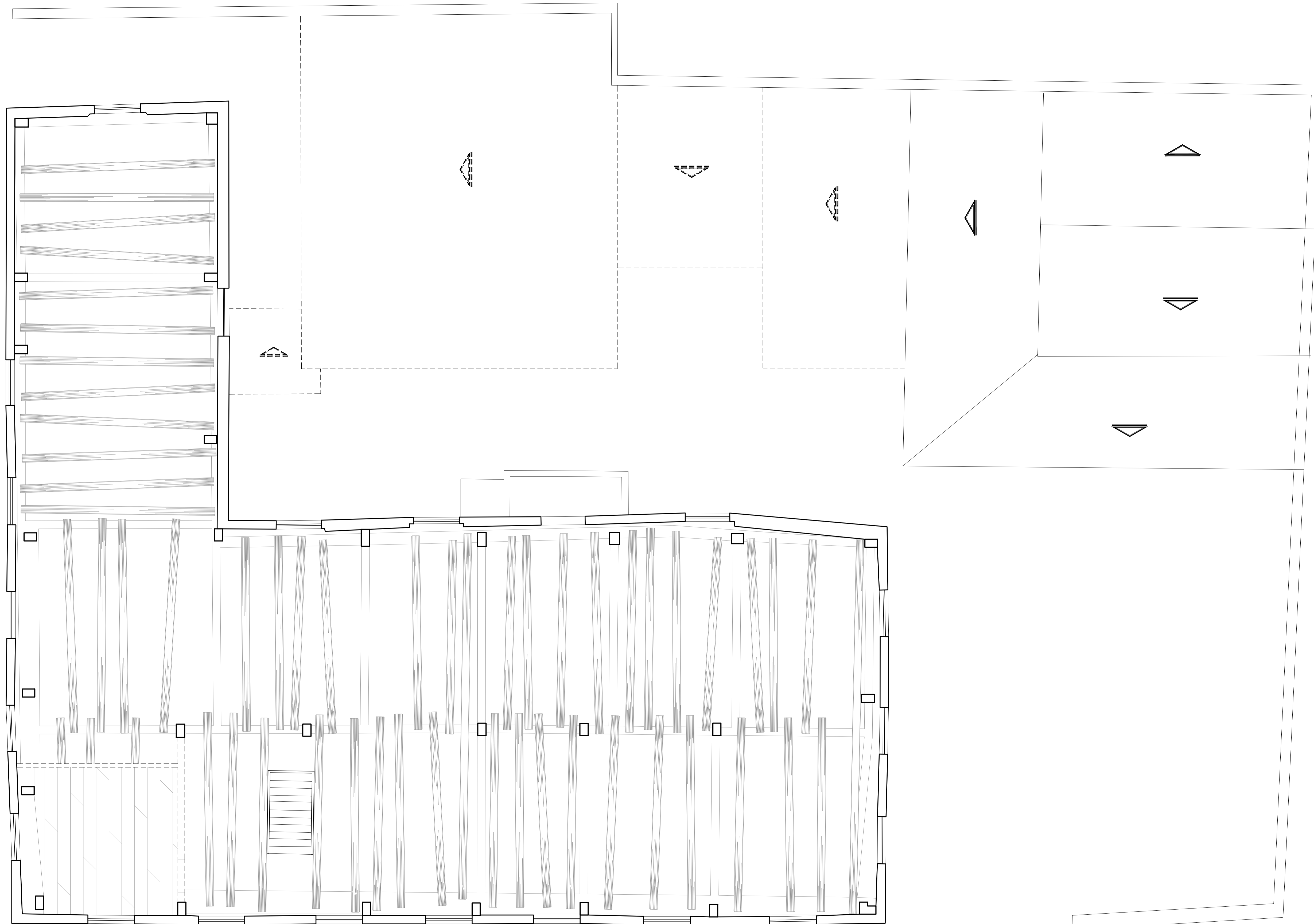
PRIMEIRA FASE DE DEMOLIÇÕES – PAVIMENTO SUPERIOR Escala 1/50
