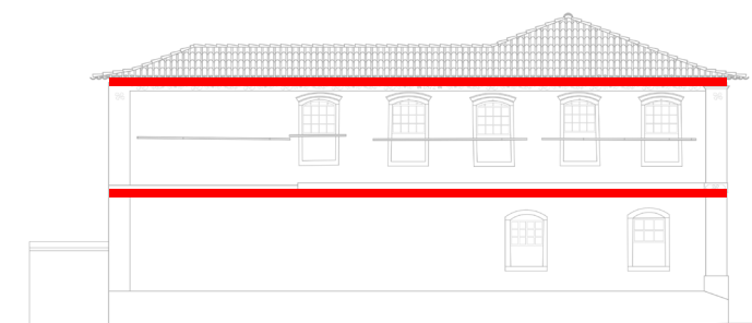
Figura 222 - Peças a serem substituídas na fachada sudoeste
