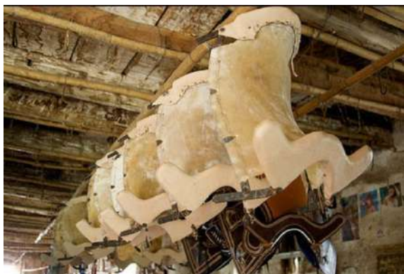
Figura 205 - Armação das selas preparadas para montagem
