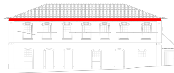
Figura 223 - Peças a serem substituídas na fachada sudeste
