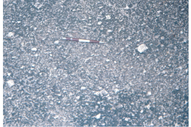
Foto 8. Textura típica das rochas da FP caracterizada pela presença de fenocristais de plagioclásio em matriz similar as rochas da FFM (ponto 601/Amostra 1845).
