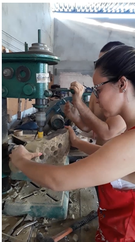
Figura (4.2) Furadeira de bancada com serra copo (amarela) acoplada para perfurar o folhelho.
