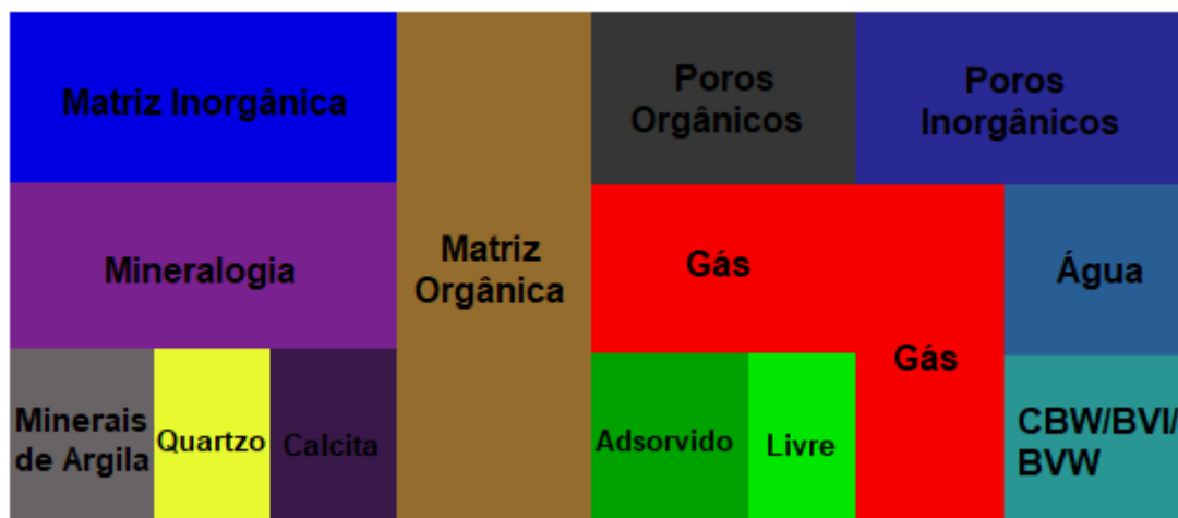
Figura (1.2) Representação esquemática dos componentes que constituem um folhelho gasoso (modificada de Mehana e El-Monier, 2016).
