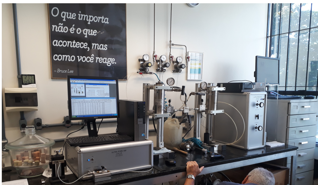
Figura (4.8) ULTRA PORE 300 à esquerda e ULTRA PERM 500 à direita. Equipamentos dotados de porta-amostras que operam até a pressão de 10.000psi.
