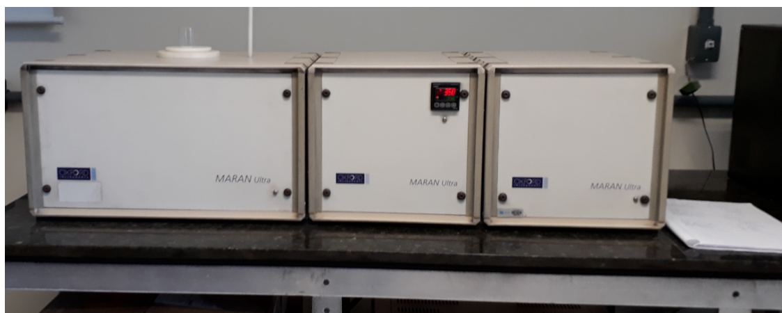
Figura (4.6) MARAN Ultra 2MHz - Espectrômetro de Ressonância Magnética Nuclear - Equipamento do Observatório Nacional.
