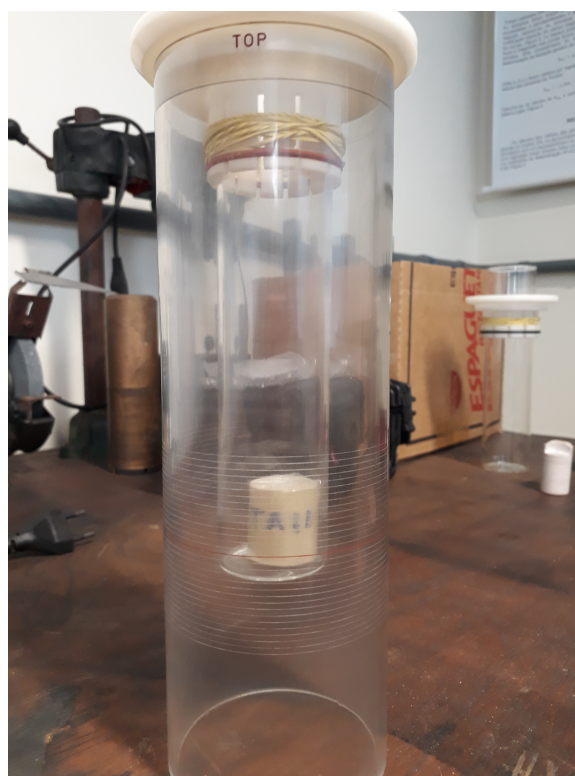
Figura (4.7) Centralização da amostra já envolvida em plástico e pronta para ser posta no espectrômetro.
