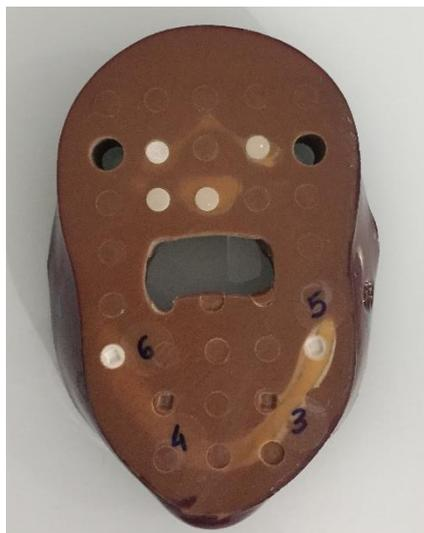
Figura 2: Fatia do simulador antropomórfico físico com diversos tarugos utilizados para inserir dosímetros no local de interesse. Fonte: Arquivo pessoal
