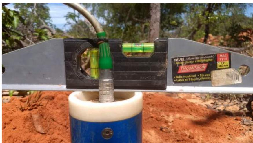
Figura 4.6: Instalação de magnetômetro horizontal.
