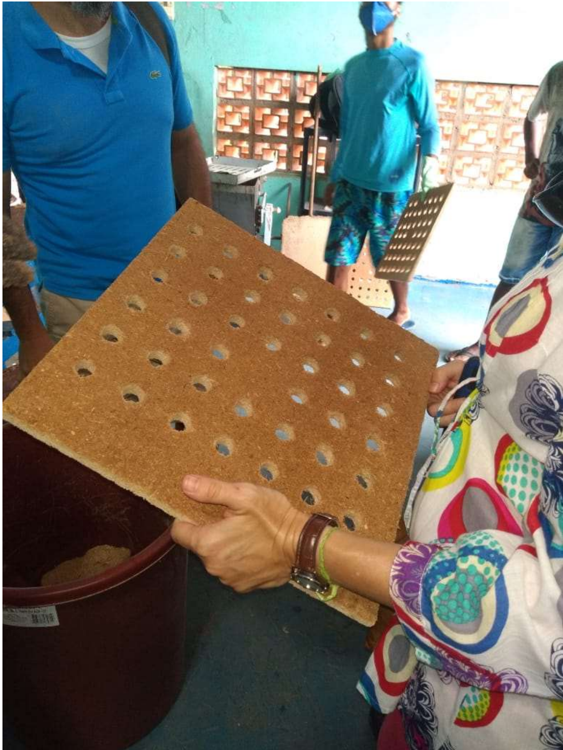
Figura 11: Placa de fibra cana-brava para revestimento acústico da sala da aula, desenvolvida por comunidade quilombola. Praia Grande, BA.
