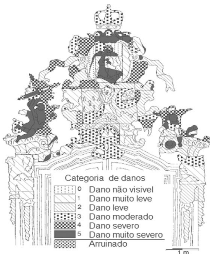
Figura 2. Mapa de níveis de degradação. Igreja de São Francisco de Assis, Ouro Preto-MG. Decoração do portal de entrada em pedra sabão. Fonte: B. FITZNER; K. HEINRICHS (2002, p. 51).
