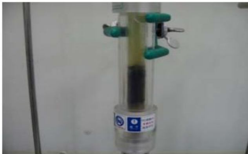
Figura 11 – Extração de óleo das microalgas pelo solvente DME. Fonte: CRIEPI, 2010.
