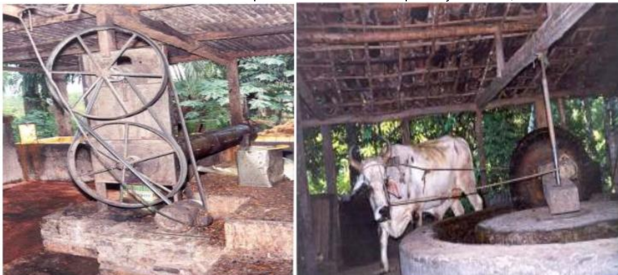
Foto 5. Rodão mecanizado à esquerda e rodão artesanal por tração animal, à direita
