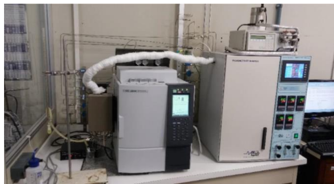
Figura 13. Unidade reacional Microactivity XS15 acoplada ao GC-2014 da Shimadzu usada nos testes catalíticos de longa duração (20h).
