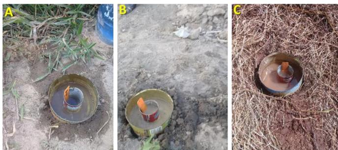
Figura 5 - A. Solo do Lixão de Irará-BA; B. Solo do Lixão de Saúde-BA; C. Solo do Lixão de São Domingos-BA. Teste de infiltração na área de estudo pelo método dos anéis concêntricos.
