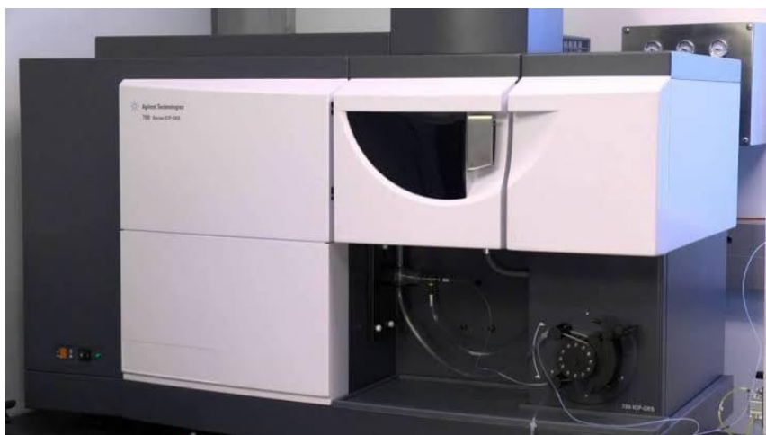
Figura 24: Espectrômetro de emissão óptica de plasma acoplado indutivamente (ICP OES) agilent 700 series. Fonte: https://www.agilent.com/cs/library/usermanuals/public/8510230100_700SeriesICP_UserManual.pdf
