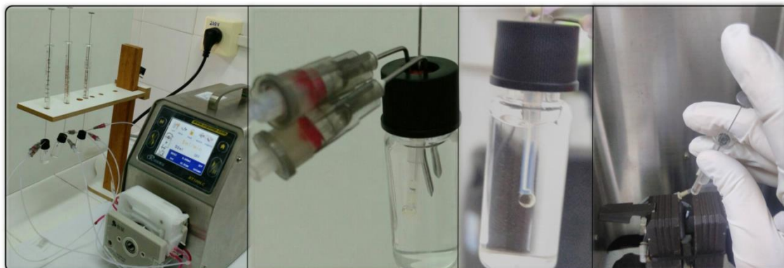
Figura 23. Fotos do sistema de microextração em linha com fluxo contínuo para a determinação de Mn(II).
