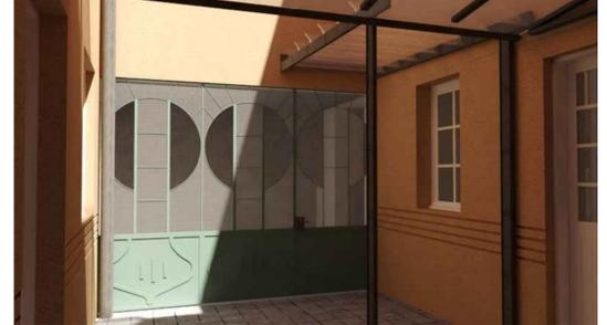
Cobertura em aço e policarbonato com sistema abre-fecha para proteção contra chuva no acesso ao sanitário.
