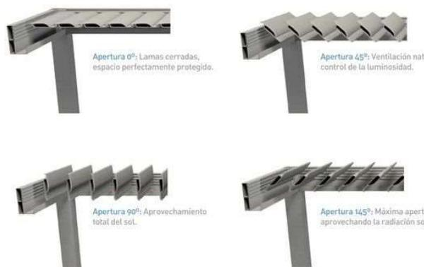
Figura 274 Modelo de funcionamento dos brises.
