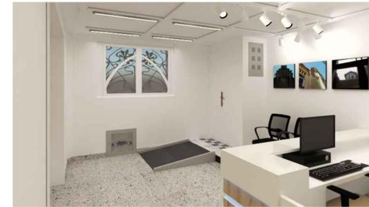
A rampa de acesso à recepção deve ultrapassar a inclinação de 8,33% devido ao pouco espaço físico e desnível a vencer. O cadeirante deve ser auxiliado.
