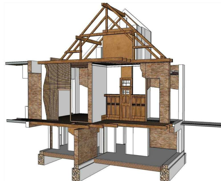
Caixa murária e paredes mestras em alvenaria de tijolos maciços, assentados com argamassa sobre fundação em sapatas corridas que, possivelmente, são em pedra.
