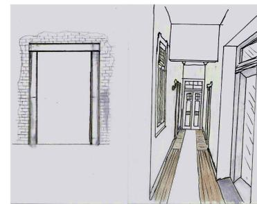
O elevador elétrico tem estrutura autossustentada e encosta no volume do passadizo através de uma viga metálica em cada lado, conectando a caixa do elevador aos dois blocos. A janela da face leste será retirada, dando lugar a um vão de porta reforçado com ombreiras e verga em estrutura metálica.
