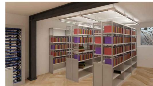
Ambiente A-03: Biblioteca. Esta grande sala abriga os ambientes A-03 e A-06. A parede existente foi removida para melhorar a ventilação. A estrutura metálica faz o reforço do vão.
