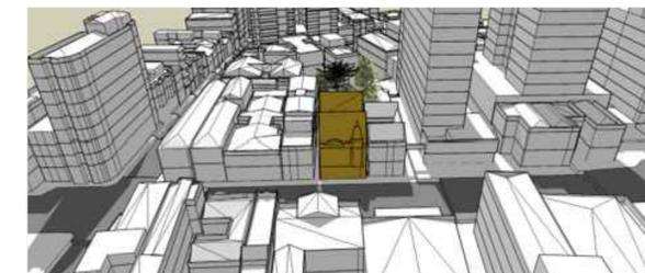
Incidência solar no período de inverno, as 12h. Sombreamento total na fachada sul durante todo o dia.
