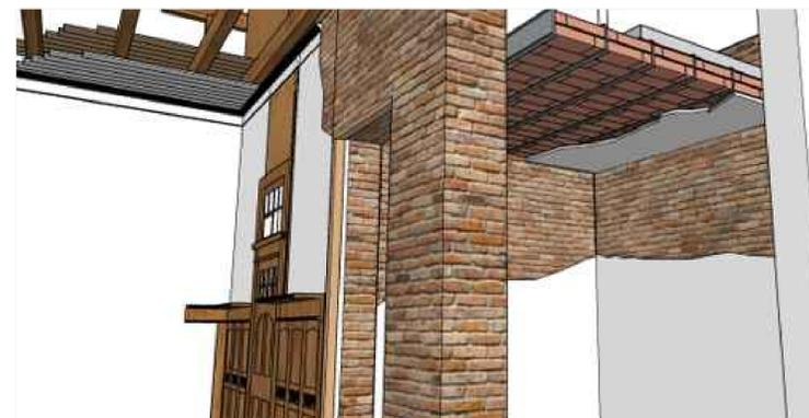
Entrepisos da despensa, jardim de inverno e terraço em laje armada de tijolos de pedra arenito (pedra de grés), vigas em aço tipo duplo "T" e tela deployer entre duas camadas de tijolos.
