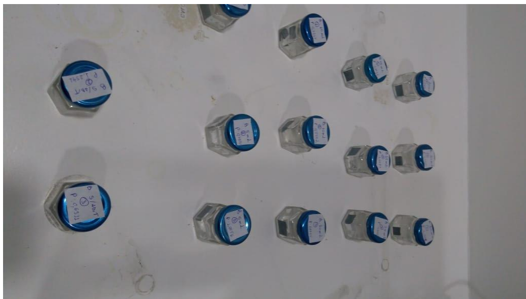
Figura 19 – Potes com solução de NaCl para realização de perda de massa.
