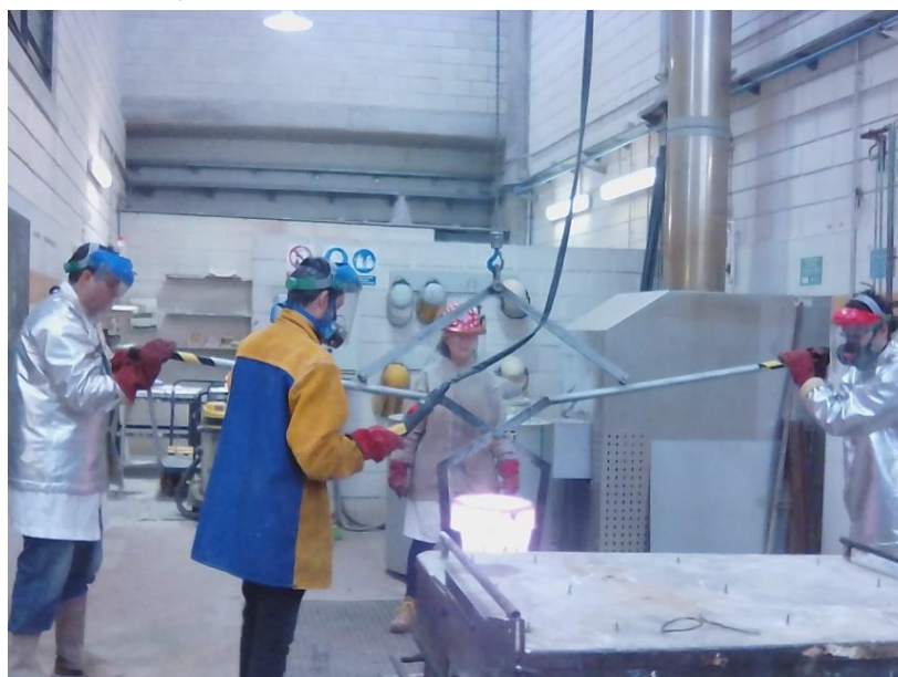
Figura 72 - Retirada do crisol/cadinho com o metal fundido, Valencia-ES, 2019.
