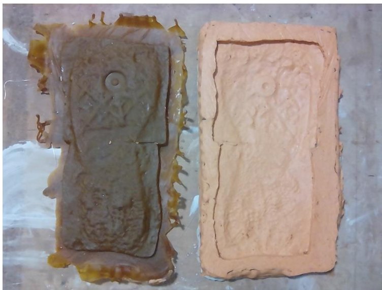
Figura 69 - Cera perdida e Molde em Escayola , Valencia - ES. 2018-2019
