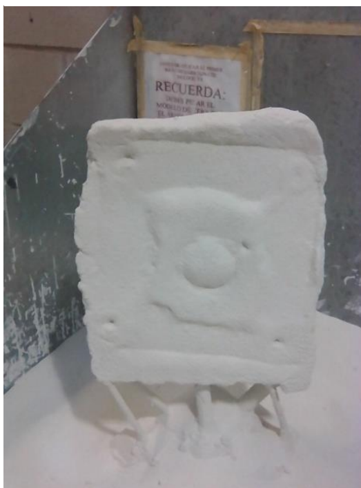
Figura 70 - Processo de aplicação da Cascarilla Cerámica , Valencia - ES, 2018-2019.
