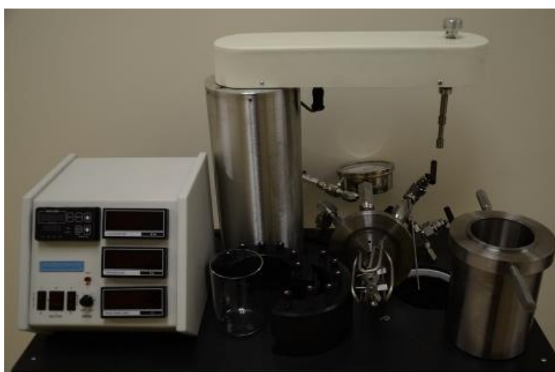
Figura 3.6 - Reator (Parr-4582) usado para otimização da transesterificação etílica.
